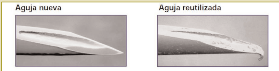
Fotografía 4: muestra el tipo de daño que puede ocasionar la reutilización de una aguja. Imagen aumentada x 370.
